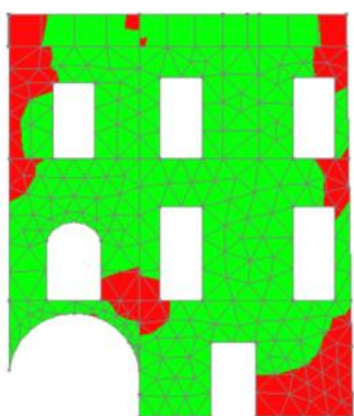
Τοίχος T10, συνδυασμός καθίζηση+G+0,30Q-Ex- 0,3Ey
