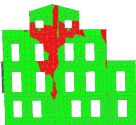
Τοίχος T7, συνδυασμός καθίζηση+G+0,30Q+Ex+ 0,3Ey
