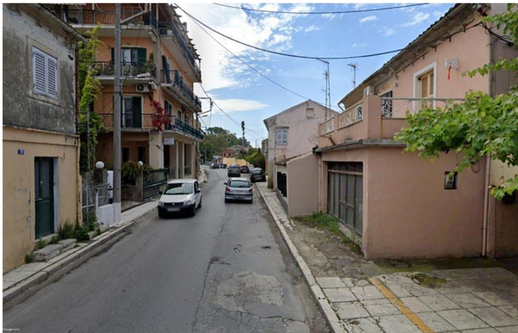
Σχήμα 5.4 Ανεπαρκές πλάτος πεζοδρομίου επί της οδού Μ. Μαργαρίτη
