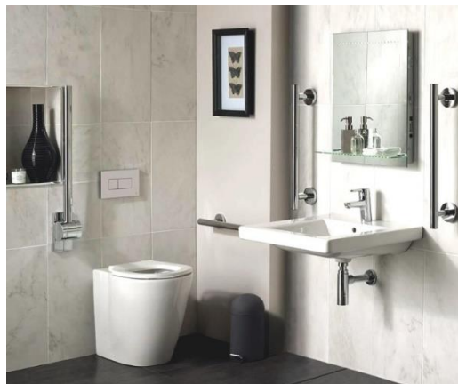
Εικ.17 Ειδικά διαμορφωμένοι χώροι υγιεινής για ΑμεΑ, πηγή: google images
